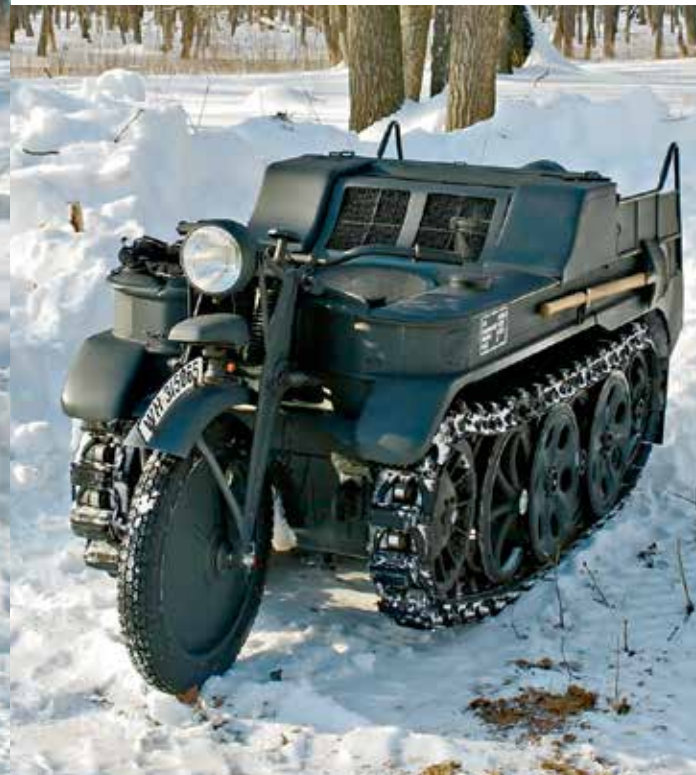
📌 Легендарный полугусеничный мотоцикл Kettenrad HK101 (SdKfz 2). С 1940 по 1945 годы компании NSU и Stoewer сделали 8871 таких аппаратов (ещё 550 машин изготовили уже после войны – для сельского хозяйства). Полуторалитровый 36-сильный двигатель от автомобиля Opel Olympia разгоняет это чудо массой 1230 кг по шоссе до 60 км/ч.
