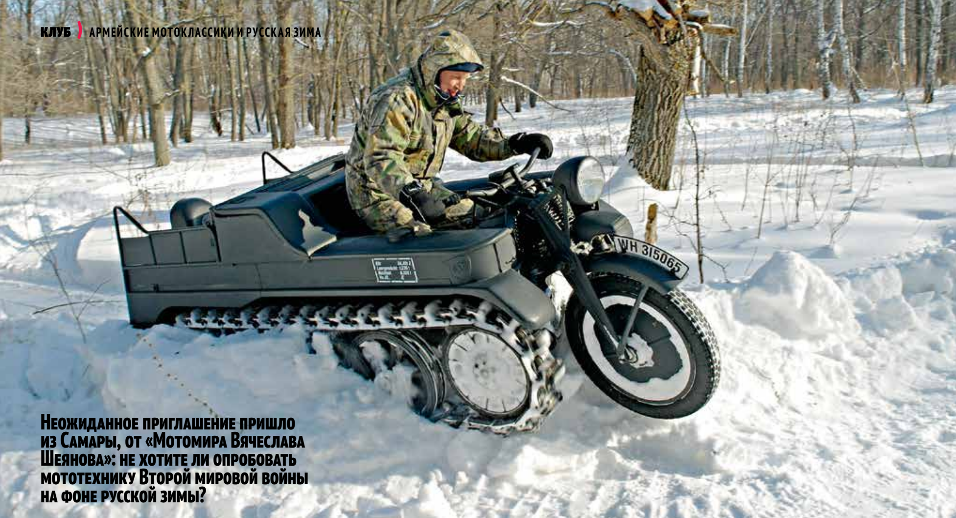
📌 Легендарный полугусеничный мотоцикл Kettenrad HK101 (SdKfz 2). С 1940 по 1945 годы компании NSU и Stoewer сделали 8871 таких аппаратов (ещё 550 машин изготовили уже после войны – для сельского хозяйства). Полуторалитровый 36-сильный двигатель от автомобиля Opel Olympia разгоняет это чудо массой 1230 кг по шоссе до 60 км/ч.
